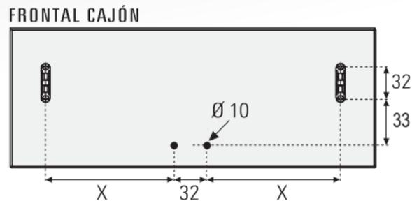
Se recomienda utilizar el estabilizador en cajones a partir de 700 mm.
